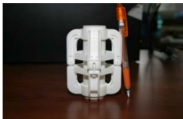
Demonstrator de senzor de torsiune făcut pentru verificarea principiului de detecție, depanabilității și identificării problemelor care pot apare la utilizarea sa. Varianta miniaturizată a fost fabricată ulterior prin 3D Printing pe metal.
